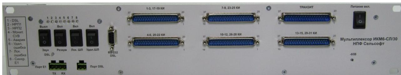
Рис.1. Внешний вид передней панели
