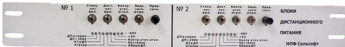
Рис. 13 - Внешний вид передней панели БДП.
